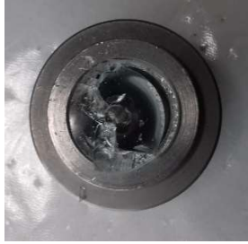
Рисунок 4 – Один из разрушенных образцов толщиной 5 мм
