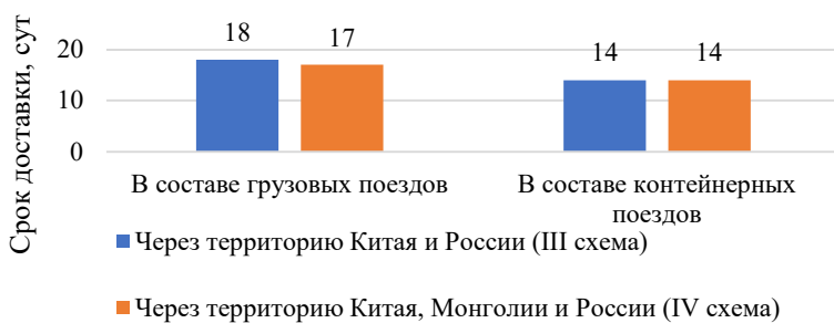
Рисунок 2 – Сроки доставки контейнеров из Шан в Нов при организации прямой железнодорожной доставки
