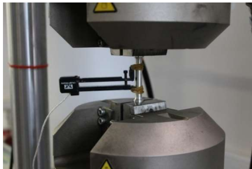
Рисунок 3 - Закрепленный на образце датчик деформаций
