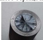
Рисунок 2 – Один из разрушенных образцов толщиной 3 мм
