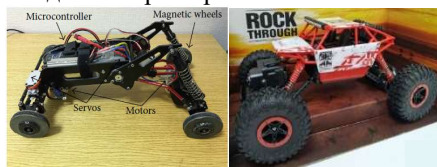
Рисунок 1 – Прототип конструкции передвижной платформы
