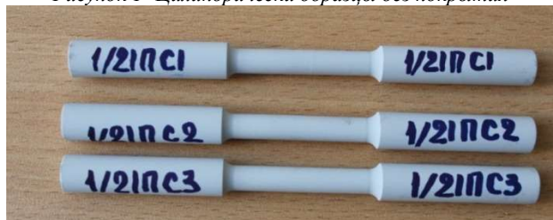
Рисунок 2 - Цилиндрические образцы с МДО покрытием
