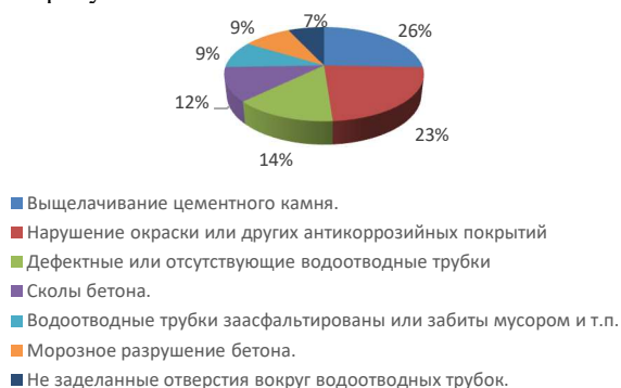
Рисунок 1 — Диаграмма распределения дефектов пролетных строений городских железнодорожных путепроводов
